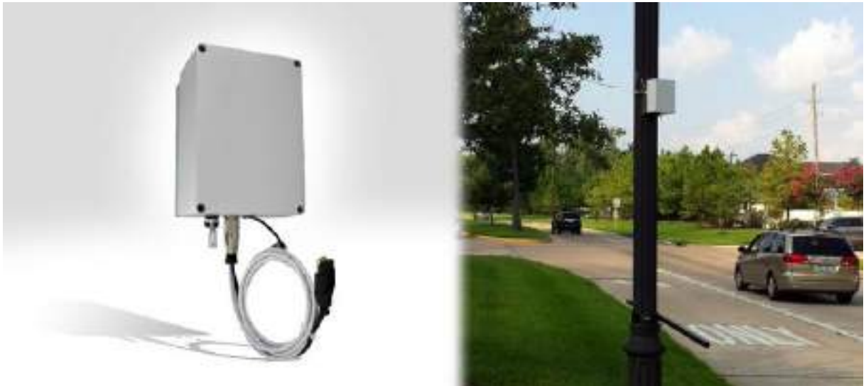
Figura 3-43 Equipo Armadillo Tracker, ejemplo de instalación
