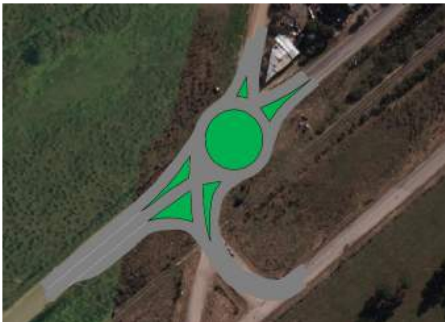
Figura 5-26 Alternativa de intervención en Camino Berrondo y Calle 60 mediante glorieta
