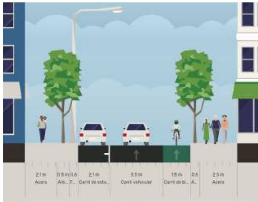
Figura 5-32 Sección transversal recomendada
